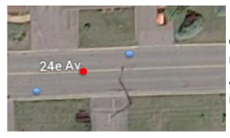
Les délinéateurs flexibles installés en diagonale permettent d'étendre la mesure sur une distance d'environ 20 m. Contrairement aux mesures initiales qui sont installées sur une même ligne perpendiculaire à la rue.
